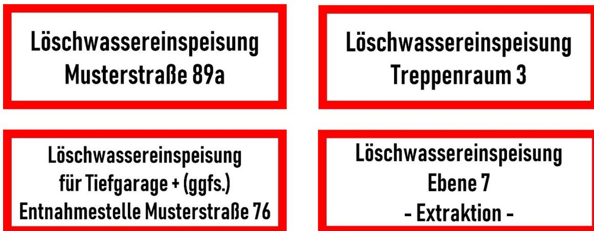
Abb. 1: Beispiele für die Kennzeichnung von Einspeisestellen
